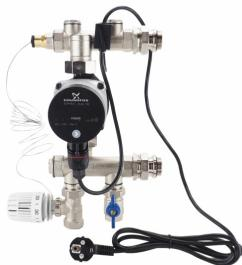
**Aceasta vana de amestec** face ca folosirea distribuitoului modular deschis sa fie alegerea potrivita pentru sisteme de incalzire la temperaturi ridicate. Vana amesteca apa calda venita din cazan cu apa din return si ofera sistemului de incalzire prin pardoseala, temperatura optima de functionare.
